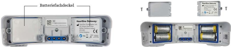
3. Legen Sie die vier mitgelieferten CR123A Batterien ein. Vergewissern Sie sich, dass die Batterien wie im Batteriefach des HeartSine Gateway gezeigt eingelegt sind.
